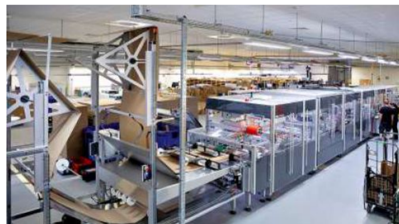
Im Handumdrehen eingetütet: die Verpackungsmaschine Genesys im Fotograflabor von Orwo in Wolfen
